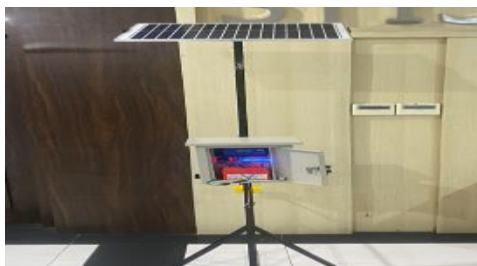
Gambar 3. Inovasi Teknologi Alat Deteksi Dini Bencana Pesisir
